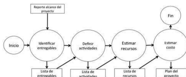
Figura 7 Fase de Planificación; detallado de actividades.
