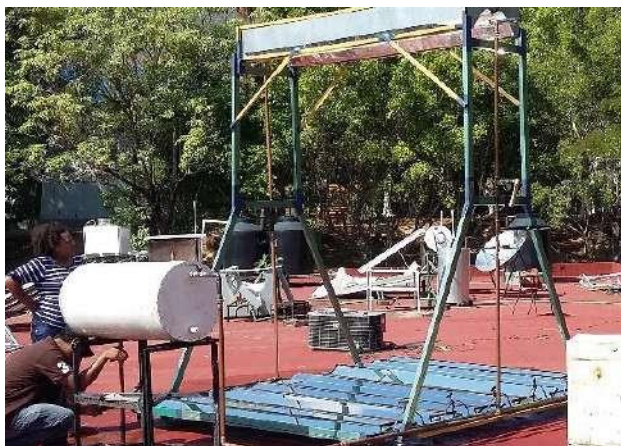
Figura 3.- Concentrador parabólico lineal con sus espejos reflejantes.
