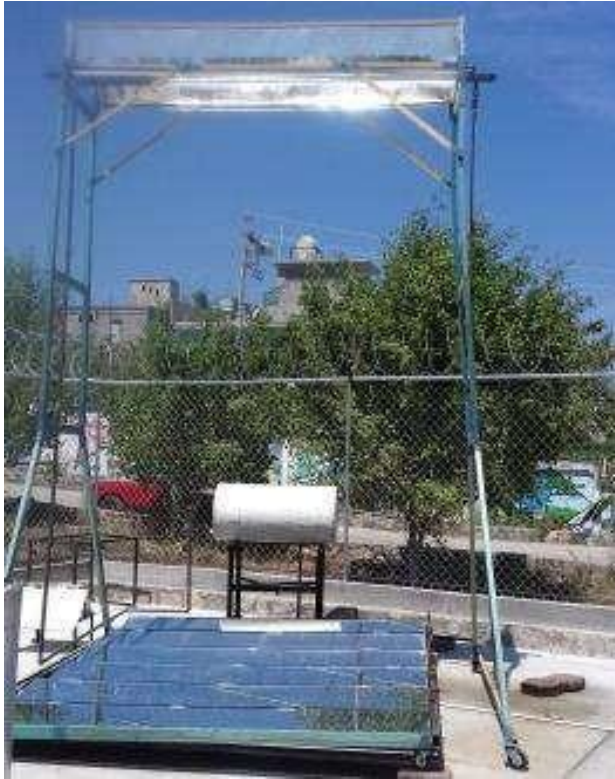
Figura 9.- Concentrador CPC con lámina de aluminio terminado en espejo, para distribuir la radiación solar reflejada por el primer concentrador horizontal de espejos.
