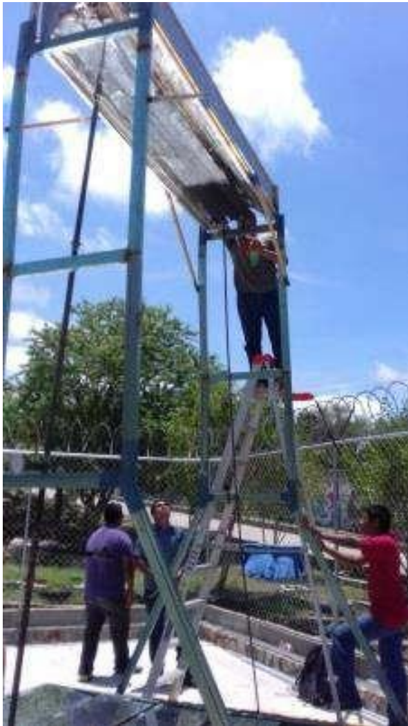
Figura 7.- Prototipo del concentrador CPC, con absorbedor colocado en el vértice de las parábolas.
