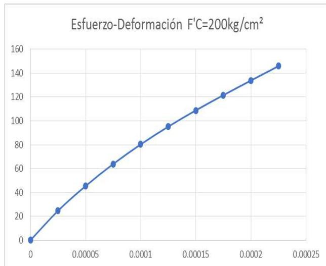
**Gráfica 3:** Esfuerzo-deformación ( $F'C=200\text{kg/cm}^2$ )
