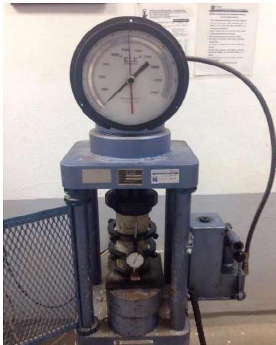
*Figura 4: Aplicación de carga axial y lectura de deformación.*
