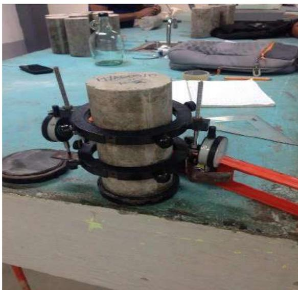
*Figura 3: Preparación del cilindro de concreto con anillos y micrometros para medir la deformación.*
