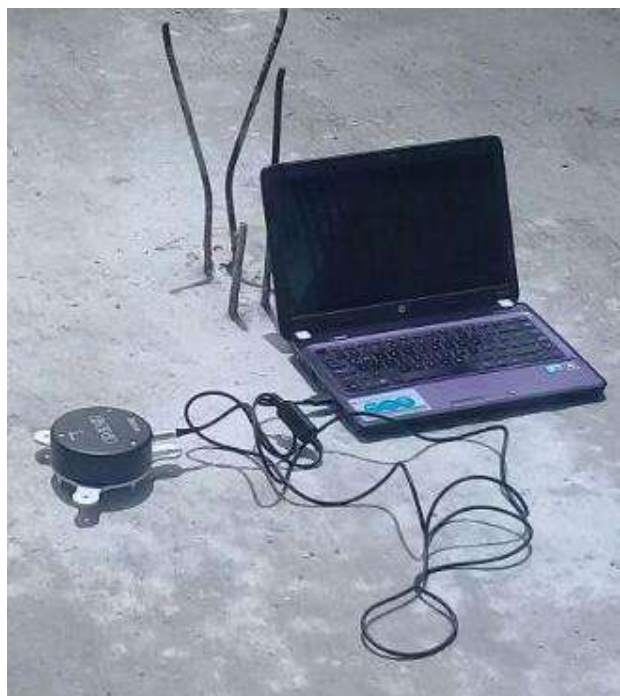
Imagen 3: Acelerógrafo para prueba de vibración ambiental (fuente propia).
