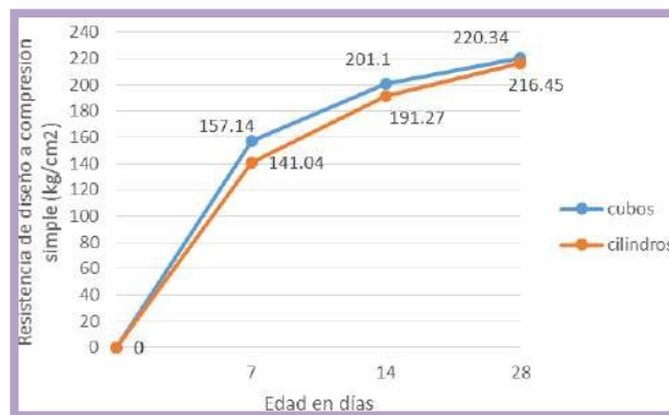
Grafico E. Muestra la Resistencia a la compresión simple de los ensayos de microconcreto a 28 días. Fuente: Elaboración propia.
