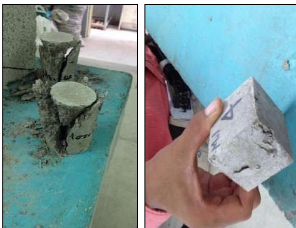
Figura 4.6 Fallas en espécimen de cubos y cilindros de microconcreto. Fuente: Elaboración propia.
