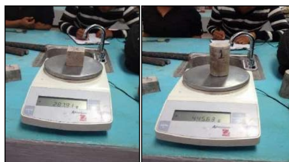
Figura 4.2 y 4.3 Peso de los cilindros y cubos de microconcreto. Fuente: elaboración propia.
