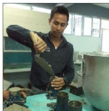
Figura 3.3 Llenado de probetas cilindros. Fuente: Elaboración propia.
