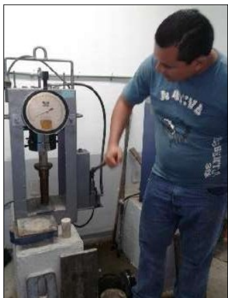
Figura 4.5 Ensayo a compresión simple. Fuente: Elaboración propia.
