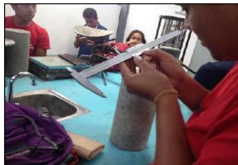
Figura 4.1 Dimensionamiento de las probetas de ensayo. Fuente: Elaboración propia.
