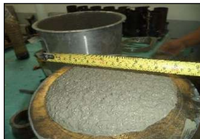
Figura 3.2 Prueba fluidez. Fuente: Elaboración propia
