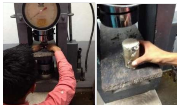
Figura 4.4 Colocación de especímenes en la prensa hidráulica. Fuente: Elaboración propia.
