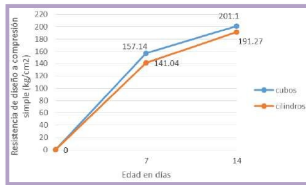
Gráfico A. Muestra la resistencia a la compresión simple en probetas de cubos y cilindros de microconcreto. Fuente: Elaboración propia.
